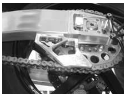
オーブントランスミッションガード例 (取付はボルト締めとする。)
