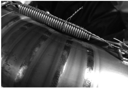
ワイヤーロック例：マフラージョイント部 (スプリングの中を通せない場合)
