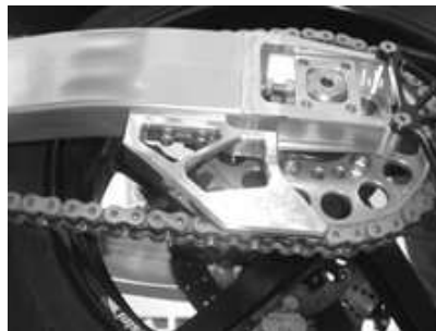
オープントランスミッションガード例 (取付はボルト締めとする。)
