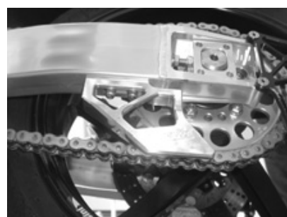
オープントランスミッションガード例 (取付はボルト締めとする。)
