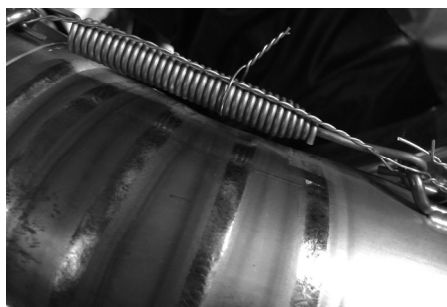
ワイヤーロック例：マフラージョイント部 (スプリングの中を通せない場合)
