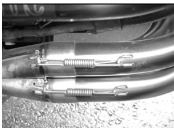
ワイヤーロック例：マフラージョイント
