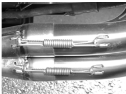
ワイヤーロック例：マフラージョイント (ワイヤーは、スプリングの中心部を通す。)
